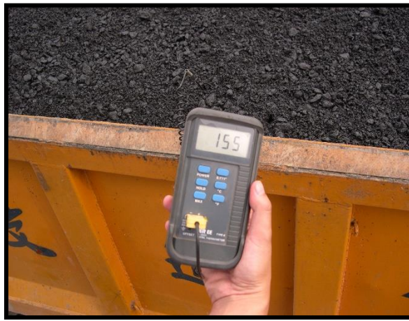
圖 5、檢驗運輸車輛上瀝青混合料溫度 [3]
